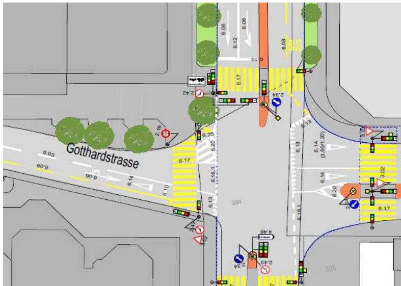
Zeichnung 1: Beispiel eines Signalisations- und Markierungsplans
