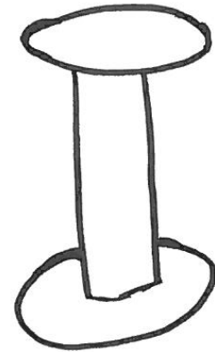
Grafik 2: Stahlpilz der Durchstanzbewehrung
